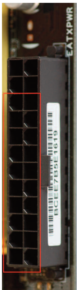
Abb. 12.17: Main Power EATXPWR (24-polig) rote Markierung: 20-polig
